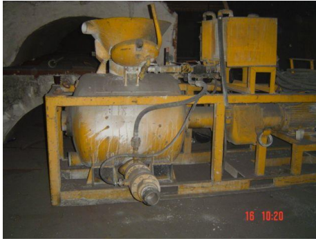
Big bag 600-800 kg ULC Mixes, Einkammer Schlämmdruckpumpe, zu gefährlich stoßweise Förderung
