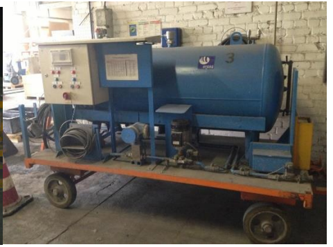
Big bag 600-800 kg ULC Mixes, Einkammer Schlämmdruckpumpe, zu gefährlich stoßweise Förderung
