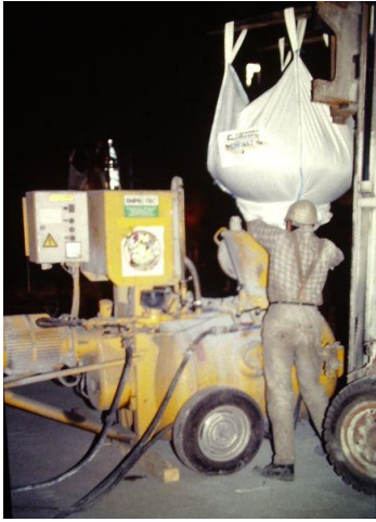
Big bag 600-800 kg ULC Mixes, Einkammer Schlämmdruckpumpe, zu gefährlich stoßweise Förderung
