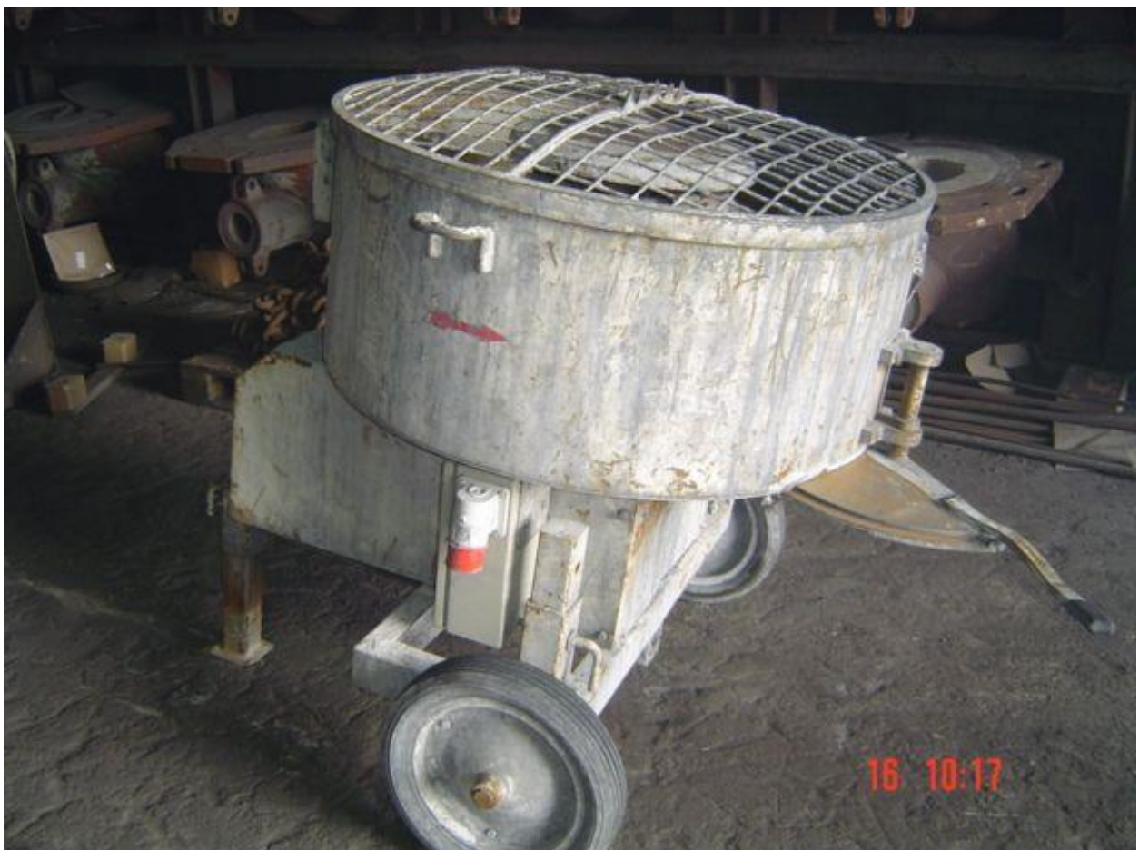
Erste Generation Zwangsmischer zum Mischen von ULC-Castable
